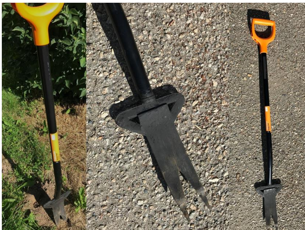
Obr. 5 Speciálně upravené nářadí pro odstraňování náletových dřevin
